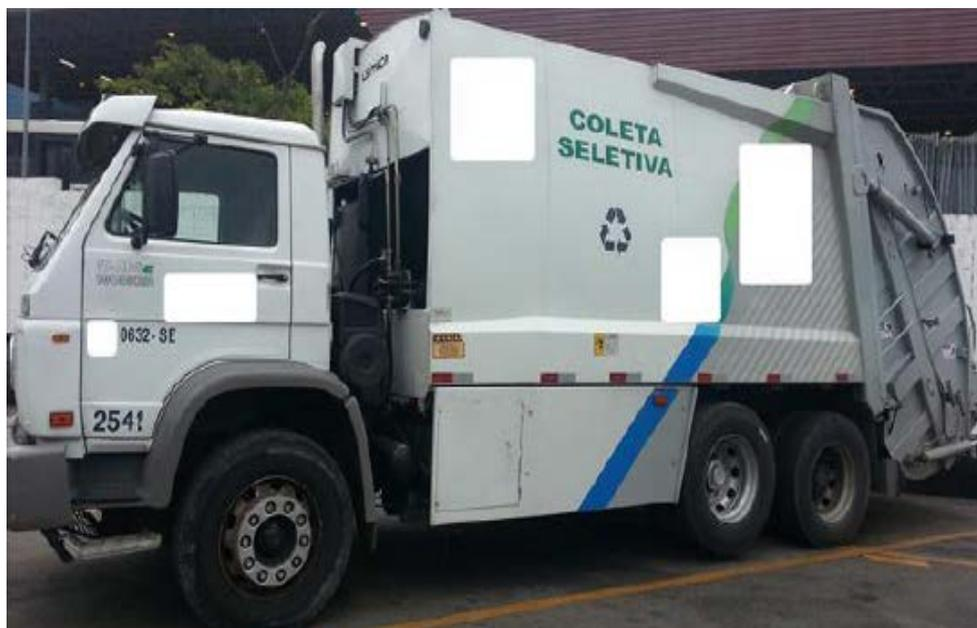
**Figura 4: Caminhão semi-compactador para coleta seletiva**
